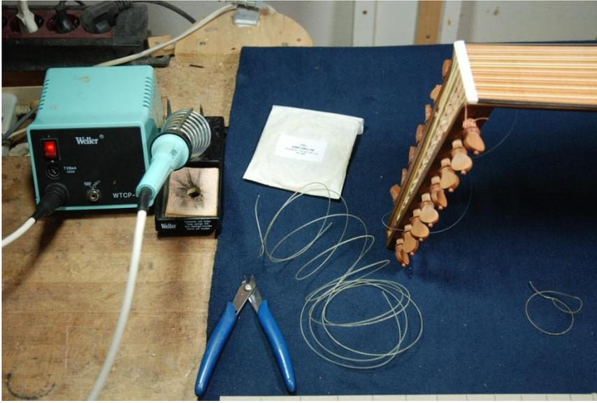
2. Bunddarm anhand der Bundierungsliste auswählen, bei Bundstärken  $> 0,8$  mm den Bunddarm wie im Bild zu sehen, durch die Finger ziehen um den Darm etwas flexibler zu machen
