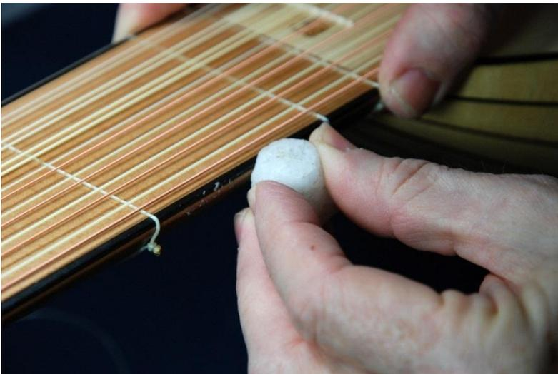
11. Nach kurzer Abkühlzeit des Verschmelzens (ca. 20 Sek) den neuen Bund an die exakte Position ziehen ...
