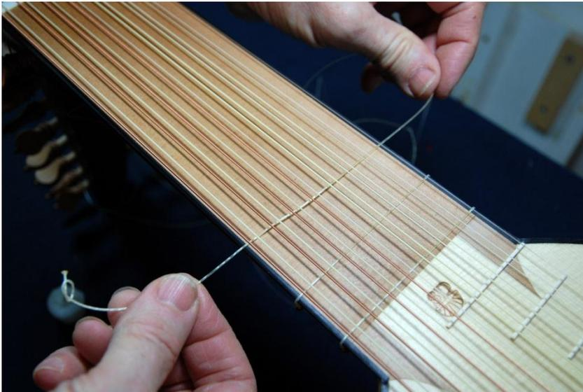
6. Bunddarm unter dem Hals in Richtung Seite mit dem Knoten ziehen. Dann das Ende durch den Knoten ziehen. Den Knoten etwas zuziehen und dann den Bunddarm anziehen.
